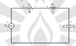
$$-V_{S} + V_{R} + V_{L} + V_{C} = 0$$
